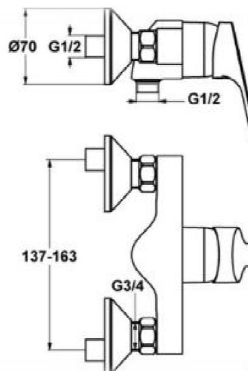
Mitigeur bain douche mural avec raccords, inverseur B/D à retour automatique. Sortie de douche ½" avec clapet anti retour intégré. La poignée est en métal. Le mitigeur est équipé d'un cartouche 2 disques céramique avec limiteur de température et limiteur de débit déverrouillable.
