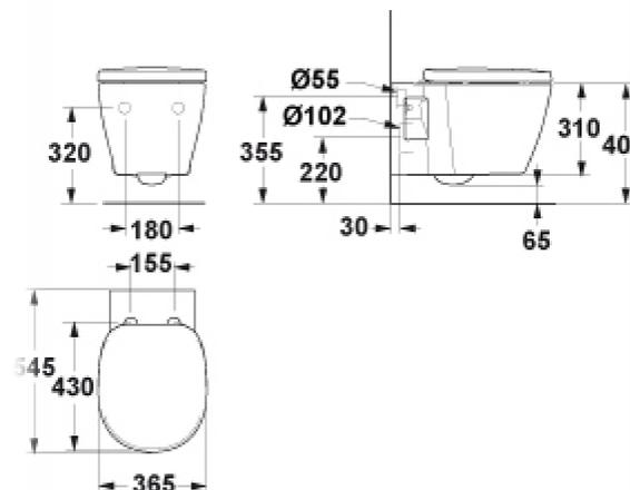
Cuvette suspendue au design moderne, chasse directe et alimentation indépendante, la matière utilisée est la porcelaine vitrifiée, avec abattant double recouvrant à charnières inox
