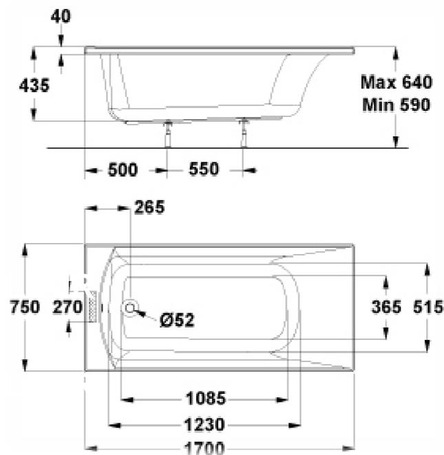
Baignoire au design sobre et contemporain avec rebords latéraux réduits en largeur pour une maximisation de l'espace intérieur. A encastrer, acrylique coulé 4mm d'une capacité de 200 litres au trop plein.
