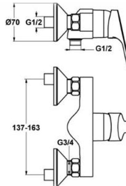
Mitigeur douche mural avec raccords. Sortie de douche ½" avec clapet anti retour intégré. La poignée est en métal. Le mitigeur est équipé d'un cartouche 2 disques céramique avec limiteur de température et limiteur de débit déverrouillable.
