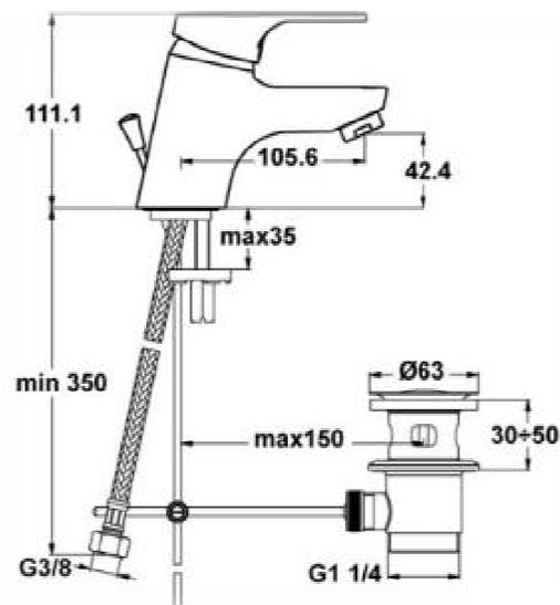
Mitigeur, à bec fixe avec aérateur anti calcaire, équipé d'un cartouche 2 disques céramique avec limiteur température et limiteur de débit déverrouillable. Poignée en métal avec tirette et vidage en métal.
